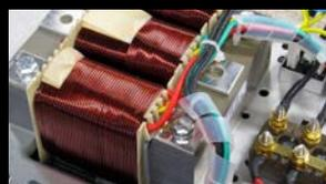
Ein Standard 400V Drehstromgenerator kann 1/3 seiner Leistung als Wechselstrom pro Phase liefern. Auf EP5000T und EP6500T(E) Stromerzeugern ist eine der Wicklungen verstärkt ausgeführt, was dem Benutzer ermöglicht die Wechselstromsteckdose bis zu max. 4kVA zu belasten.
