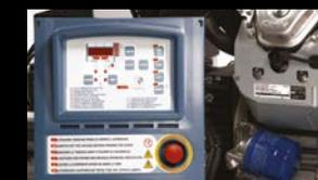
A.S.S.S. steht für Automatische Start/Stop Steuertafel bei Netzausfall: Alle Stromerzeuger mit Elektrostart können mit diesem einfachen Backup-System ausgestattet werden. Es hat ein eingebautes Batterieladegerät und einen computerisierten Selbsttest.
