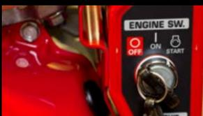
Tous les groupes électrogènes avec un E à la fin du type ont un démarrage électrique. Ces groupes électrogènes peuvent être utilisés dans les systèmes de secours et de sauvegarde. Si vous combinez un groupe électrogène à démarrage électrique avec un A.S.S.S., assurez-vous que votre groupe électrogène essence soit équipé d'un starter électrique ou automatique.
