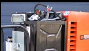
Les groupes électrogènes avec moteur bicylindre Honda sont équipés d'un jerrycan de 20 litres qui est facilement interchangeable sans devoir arrêter le moteur.
