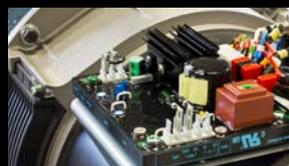
En option, le groupe électrogène peut être équipée d'un AVR. AVR signifie « Automatic Voltage Regulation » et assure une tension plus stable.
