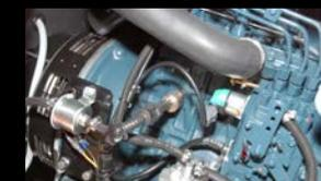
Plusieurs dispositifs de préchauffage sont offerts en option, comme le préchauffage de l'eau de refroidissement, du carter d'huile ou de l'air d'admission. Ces options/accessoires permettent à l'utilisateur de démarrer le moteur dans des conditions de froid extrême.
