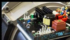
AVR réfère à « Automatic Voltage Regulator » et maintient une tension constante et stable. Il en résulte de meilleures performances pour les appareils sensibles.
