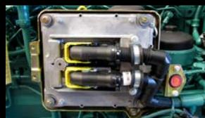
Le régulateur de vitesse électronique (Electronic Speed Governor) maintient une vitesse du moteur et une fréquence de l'alternateur constantes et stables. Combiné avec l'AVR, il en résulte de meilleures performances pour les appareils sensibles. Tant le E.S.G. que l'AVR sont nécessaires pour le fonctionnement en parallèle de plusieurs groupes électrogènes.
