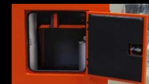
Die Inspektionsplatte wurde durch eine Inspektionstür ersetzt, um beim Reinigen des Kühlers leicht zugänglich zu sein.
