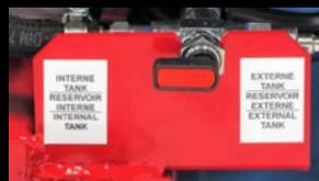
Voulez-vous augmenter le nombre d'heures d'autonomie du groupe électrogène? L'option vanne à trois voies permet de passer à un réservoir externe.
